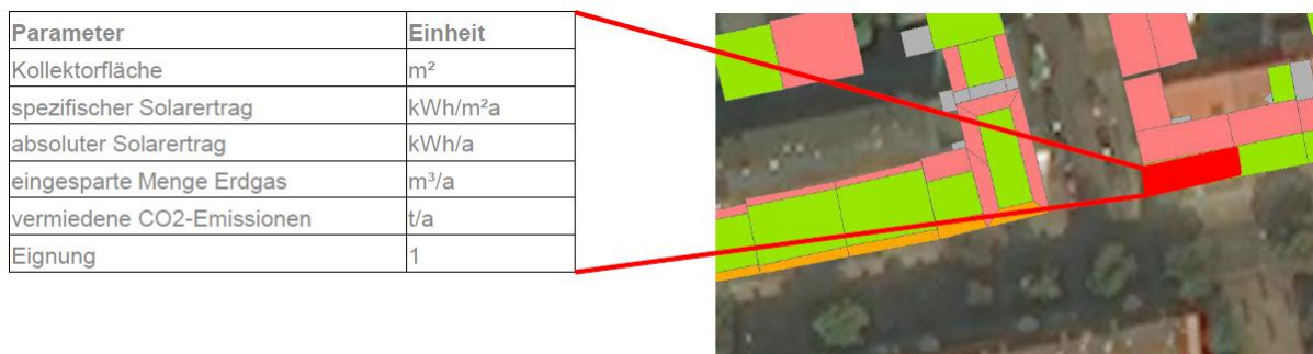
Abb. 65 Auswahl technischer Parameter Solarthermie
